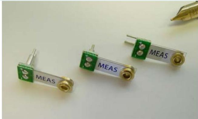
MiniSense 100是一款采用悬臂梁结构的低成本的振动传感器，通过在尾部加载一个质量块能在低频下产生很高的灵敏度。其插针结构易于安装和焊接，水平安装和垂直安装的可选择性适合于不同的高度。传感器工作区域采用自屏蔽结构，能有效地防护RFI/EMI。柔性PVDF的一端固定，另一端悬空，使其能经受高频的冲击载荷。传感器有良好的线性度和动态测量范围，可以用来监测连续振动和冲击。
